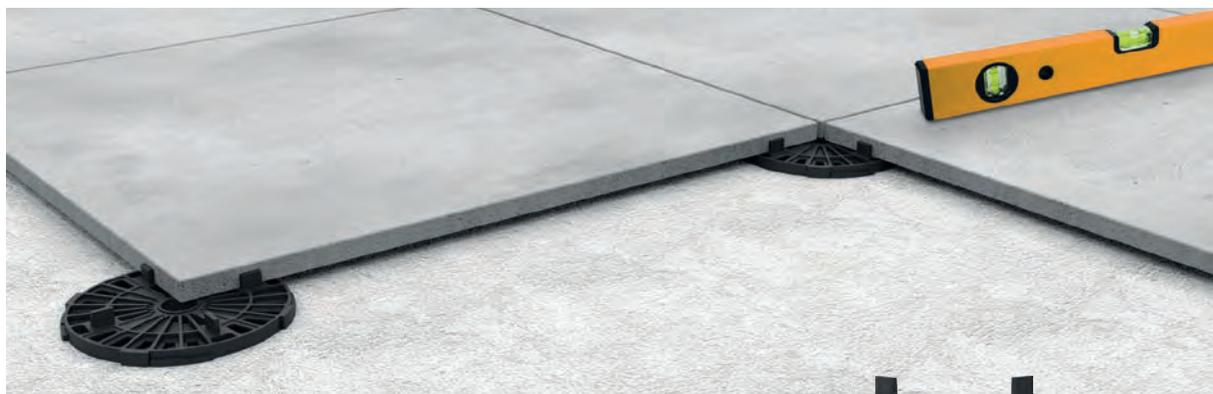
高さ調整敷設パットSP-10は製品をスライドすることで、高さ10mmから15mmの範囲で1mm単位での調整が可能な敷設パットです。20mmセラミックタイルを、セメントモルタルや接着剤などを使用せずに敷設施工することが可能です。
